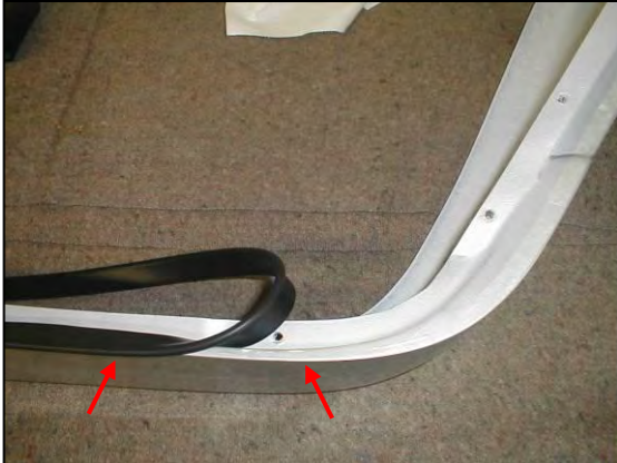
Bild 24: Verbreiterung mit Kederband Figure 24: Fender flaring with weather strip
