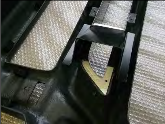
Bild 17: Lufteinlass und Strömungskanal Figure 17: air intake and flow channel
