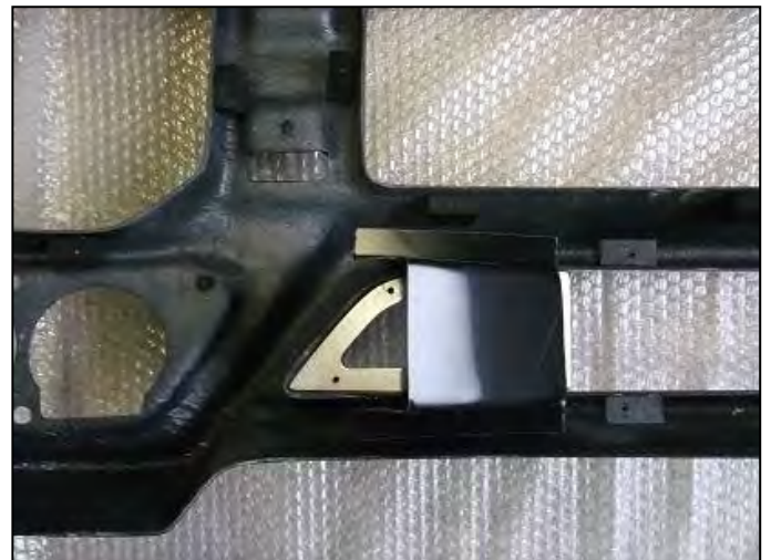
Bild 16: Lufteinlass und Strömungskanal Figure 16: air intake and flow channel
