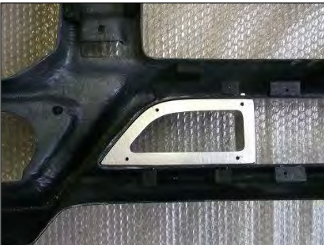
Bild 15: Lufteinlass für Strömungskanal Figure 15: air intake for flow channel
