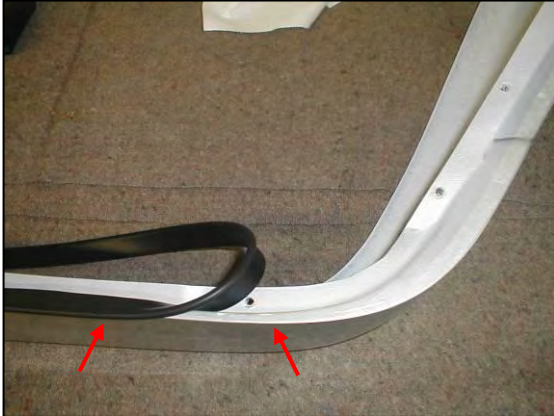
Bild 20: Verbreiterung mit Kederband Figure 20: Fender flaring with weather strip
