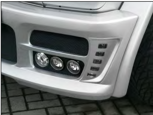
Bild 14: Leuchtenset Frontstoßstange Figure 14: Lamp set front bumper
