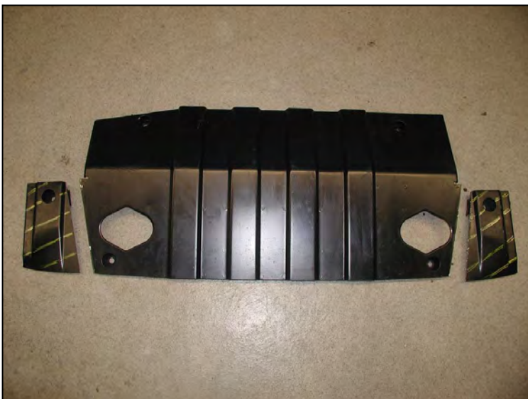
Bild 24: Unterfahrerschutz Figure 24: underride guard
