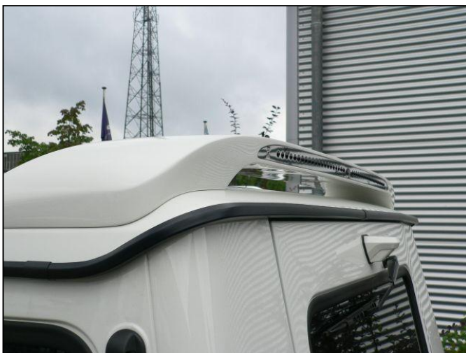
Bild 4: Position Dachspoiler Fig. 4: position of roof spoiler
