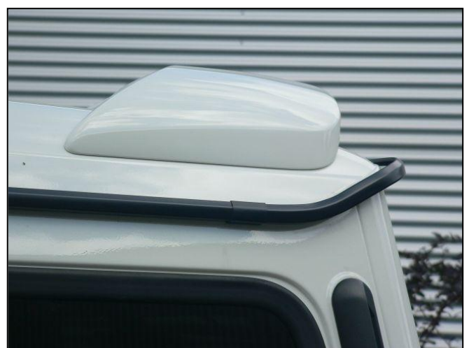
Bild 5: Position Dachspoiler Fig. 5: position of roof spoiler
