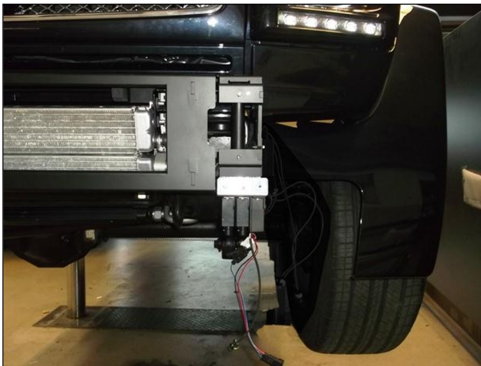
Bild 7: LED Steuergerätemodul an Konsole Figure 7: LED control unit module on cross beam
