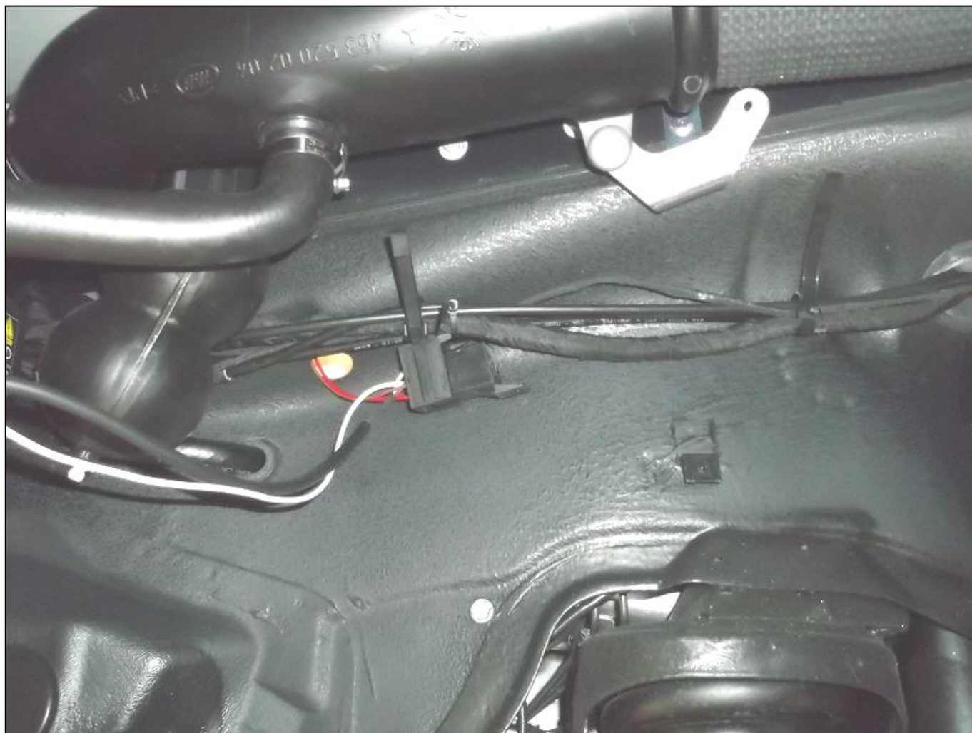
Bild 2: Befestigung des Relais Figure 2: Fixing of the relais
