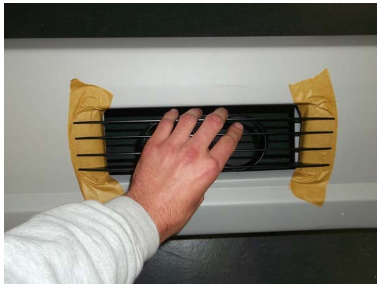
Bild 4: Lampengehäuse aufsetzen Figure 4: Fit in the lamp housing
