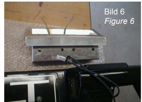
7. Die Rückfahrcheinwerfer und die Nebelschlussleuchten der ART-Heckleuchteneinsätze demontieren. ART-Kabelbaum durch Integraleinsatz führen.
