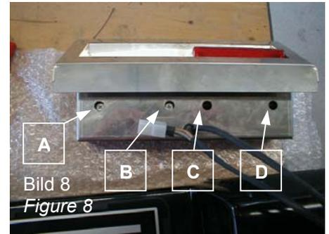
9. Heckstoßfänger wieder an das Auto montieren. Verkabelung mit beigefügtem Steckergehäuse an Originalkabelbaum anbringen.
