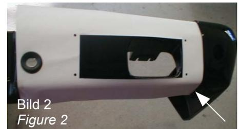
3. Schablone auflegen und an der Anlegekante Stoßfänger (siehe Schablone) ausrichten. Bohrpunkte markieren. Ausschnitt B (siehe Schablone) anzeichnen und aussägen. Hinweis: Auf Freigängigkeit zwischen den Stoßfängerhaltern achten. Siehe Bild 2, 3 und 4.
