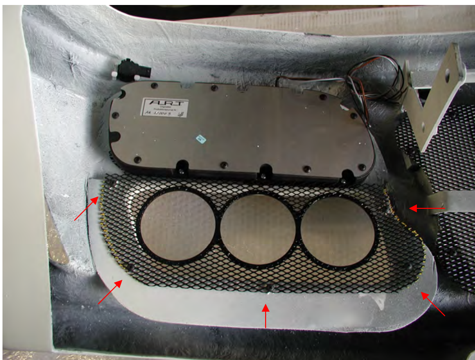
Bild 3: ART Frontschürze (Beispiel) von hinten links, mit Scheinwerfergitter Fig.3: ART front spoiler bumper (example) from behind, left, with headlamp grid
