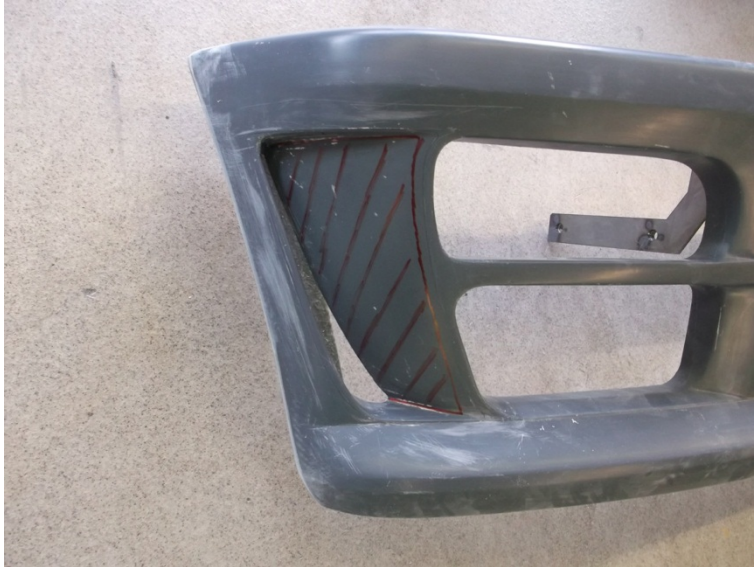
Bild 3: Bereich zum Aussägen Figure 3: Marked area for sawing
