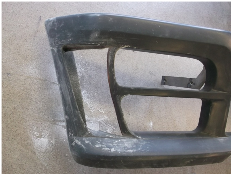
Bild 4: Ausgesägter Bereich Figure 4: Sawed area
