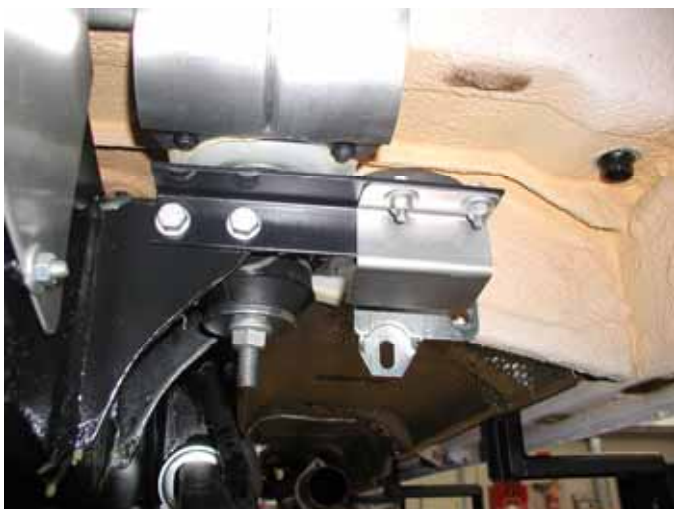
Bild 2: auszutauschender Serienhalter Fig. 2: original exhaust bracket
